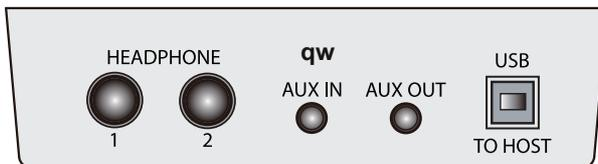
Jacks de conexión externa (en la parte inferior izquierda del piano)
